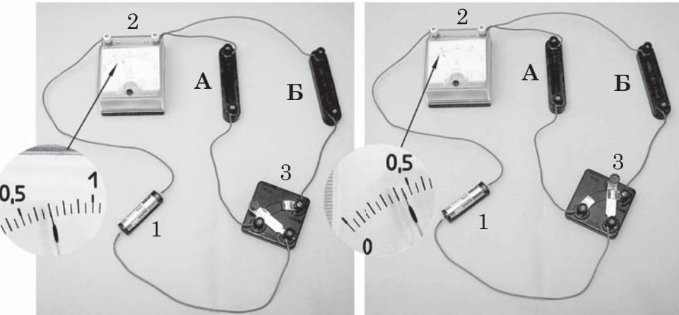
1. Визначте напругу на полюсах гальванічного елемента, коли струм тече в резисторі А.
